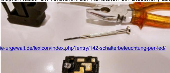
Zwar hat der Schalter eine Kunststofflinse, aber du kannst trotzdem den LED leicht schräg anbiegen, damit er das Symbol im Schalter genau anstrahlt.
