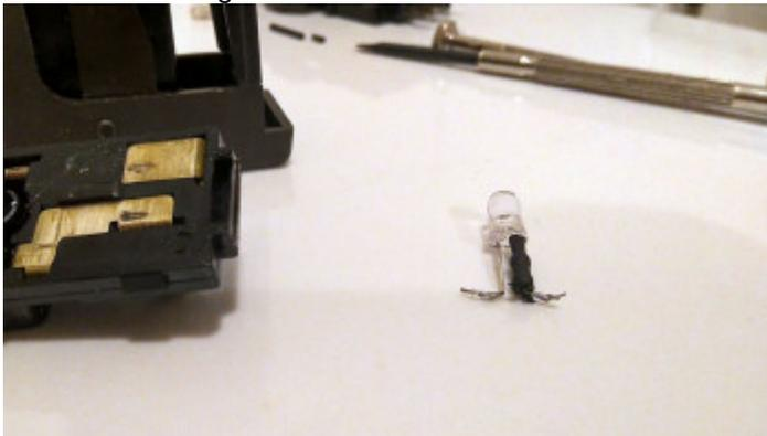
2. Jetzt wird der Sockel vom Schalter zerlegt. **Wichtig: stelle sicher, dass der Schalter im Zustand „ausgeschaltet“ ist, das macht den Zusammenbau nachher einfacher.**
